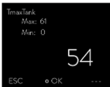
Fig. 38: Enter Tmax (here TmaxTank)
